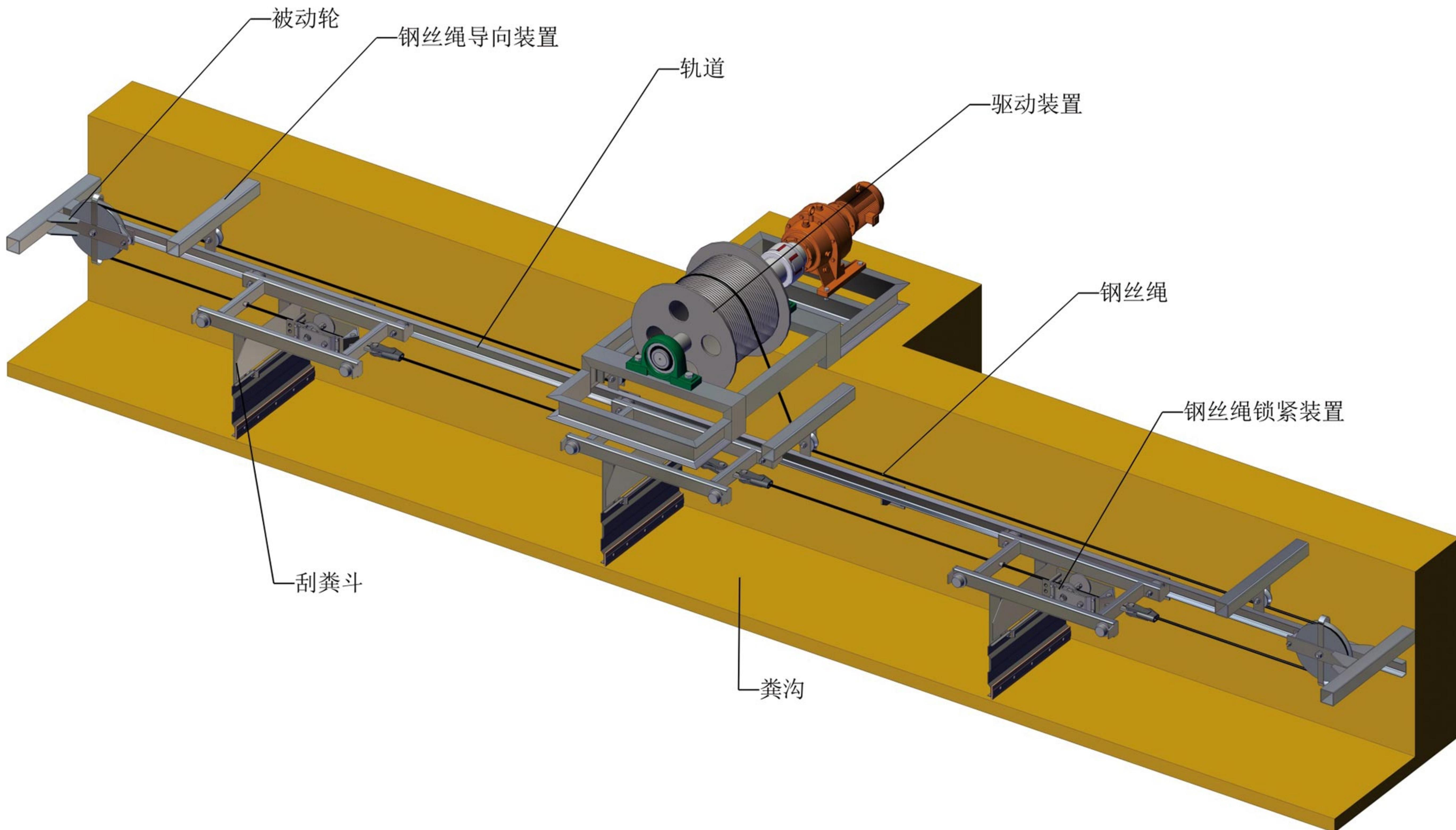
该刮粪斗机器电气控制系统由触摸屏、PLC及变频器等电器元件组成，通过触摸屏手动或自动启动停止按钮对牛舍刮粪斗系统进行运转控制。操作简单，灵活控制。
